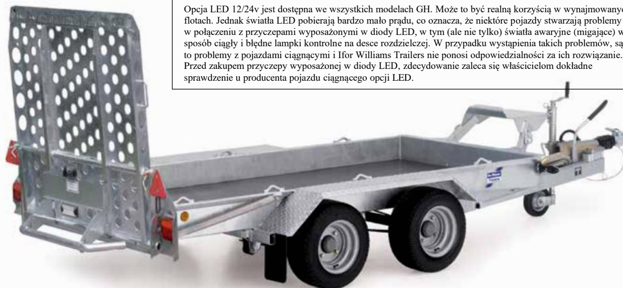
GH94 opony 195/55R10C - pełna rampa najazdowa 1.2m (3'9"). Opcja świateł 12/24v LED
